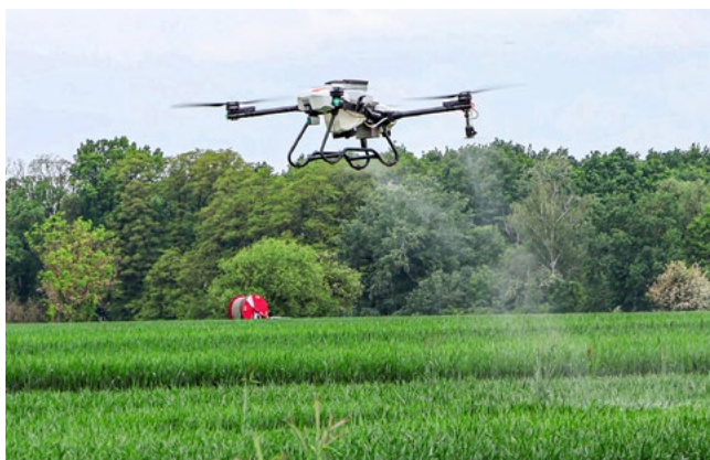
Rys. 3. Aplikacyjny bezzałogowy statek powietrzny ABZ L30 podczas badań prowadzonych przez Instytut Ochrony Roślin – Państwowy Instytut Badawczy dotyczących możliwości wykorzystania BSP w ochronie roślin.
