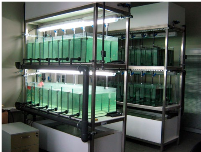
Fotografia 1. Niewielki akwariowy obieg recyrkulacyjny przygotowany do produkcji materiału zarybieniowego (foto: T.K. Czarkowski)
